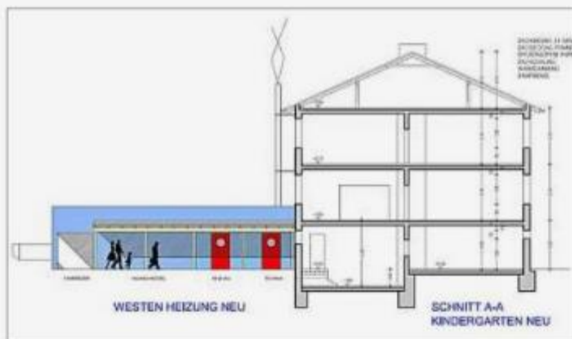
In Walburgskirchen erfolgt der Umbau überwiegend im Bestandsgebäude. Neu ist ein Anbau im Westen für die geplante Hackschnitzel-Heizung plus Fahrradhalle und Eingangsbereich. – Foto: Rlinner
