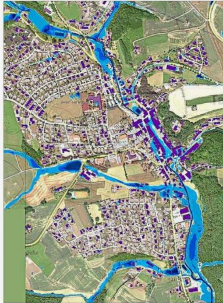
Die Gefährdungskarte für Tann, erstellt für eine 100-jährige Sturzflut. Hier sieht man in verschiedenen Blaustufen die Bereiche, die vom Wasser erfasst werden. Lila eingefärbt sind die gefährdeten Häuser. Dabei wird eine Wassertiefe von mindestens fünf Zentimeter, die auf das Grundstück fließt, angenommen. – Fotos: Grafiken aquasoli
